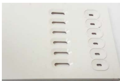
Рис. 2. Кассета с тест-полосками, разработанная для использования в роботизированной системе
