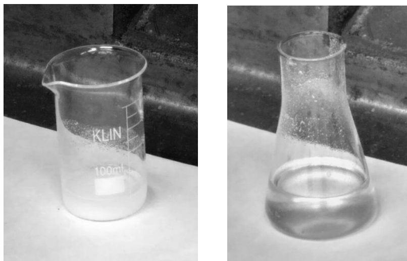
Рис. 1. Синтезированные гидрат и ксерогель оксида титана
