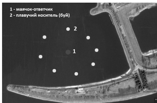
Рис. 2. Схема эксперимента. Полигон «Старое Русло» на Ивановском водохранилище (красные точки – трек перемещения буя, желтые окружности – расстояния до донного модуля)
